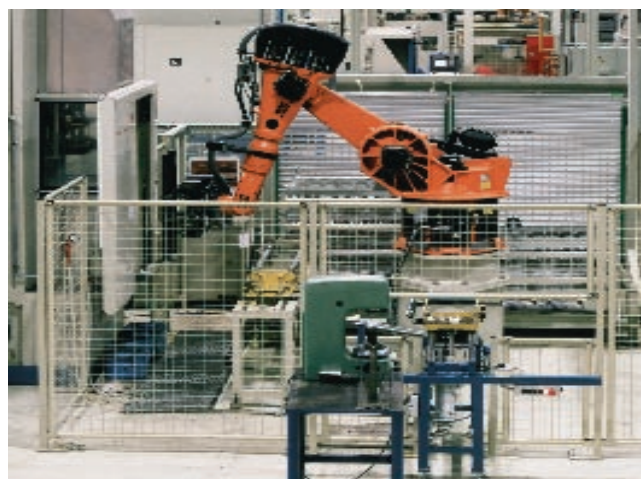
Zweispindlige MF- Induktionshärtemaschine mit Roboterbeladung
